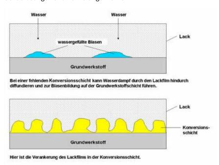
Feuchtigkeit, einschließlich Wasser, kann je nach Lage und Beanspruchung durch den Lackfilm bis zum Grundmaterial vordringen und dort teilweise kondensieren. Dies kann dann zu Blasen oder Lackablösungen führen, insbesondere wenn die Schicht mechanisch beansprucht wird.
